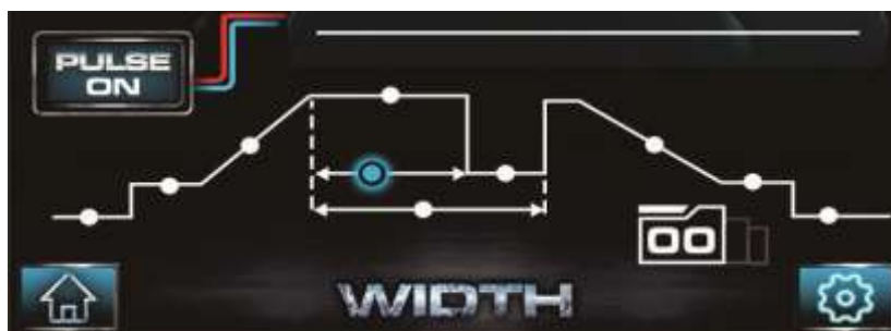
Diagrama dos parâmetros de soldagem quando pulsado:
