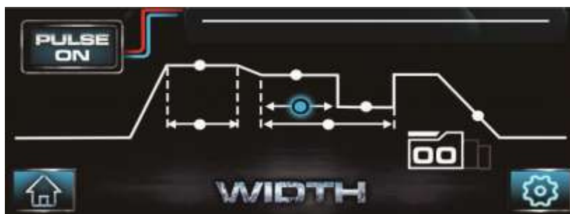
Diagrama dos parâmetros de soldagem quando o pulso está ligado:
