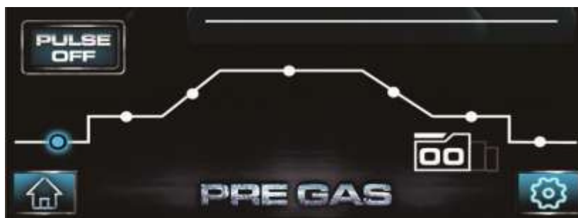
Diagrama dos parâmetros de soldagem quando pulsado:
