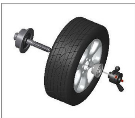
Eixo principal -roda-interior>cone adequado (cabeça pequena para o interior) - porca de pega rápida
