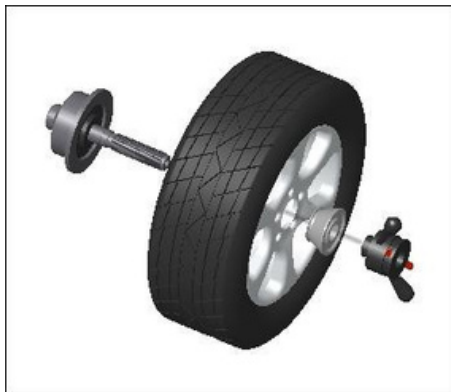
Eixo principal roda cone adequado (cabeça pequena para dentro) - porca de pega rápida
