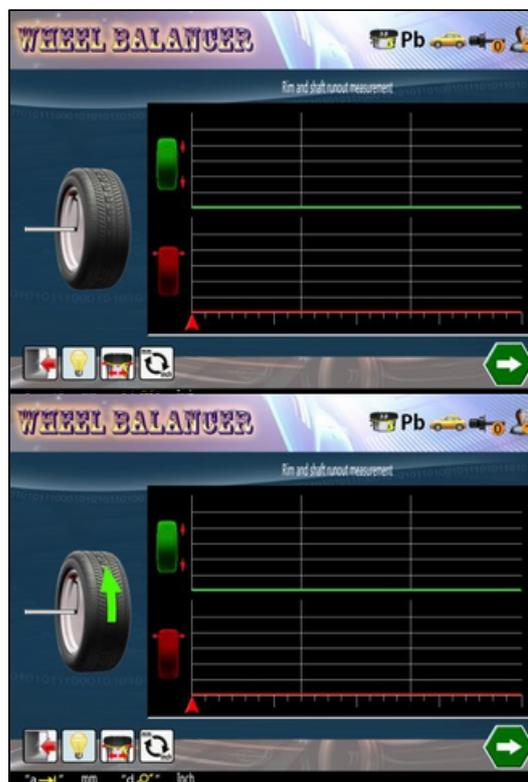
Fig.69 Medição da excentricidade (PP)
