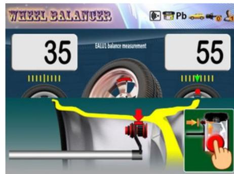
Fig.54 Operação de colagem exterior da EALU1
