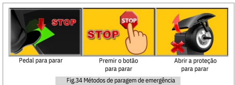
Fig.34 Métodos de paragem de emergência
