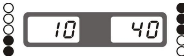
Fig. 13 Mover lentamente a roda no sentido anti-horário, até que o LED direito se acenda completamente (Fig.14)
