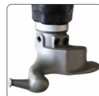
Cabeça em aço com peças de proteção em plástico para evitar danos nas jantes.
